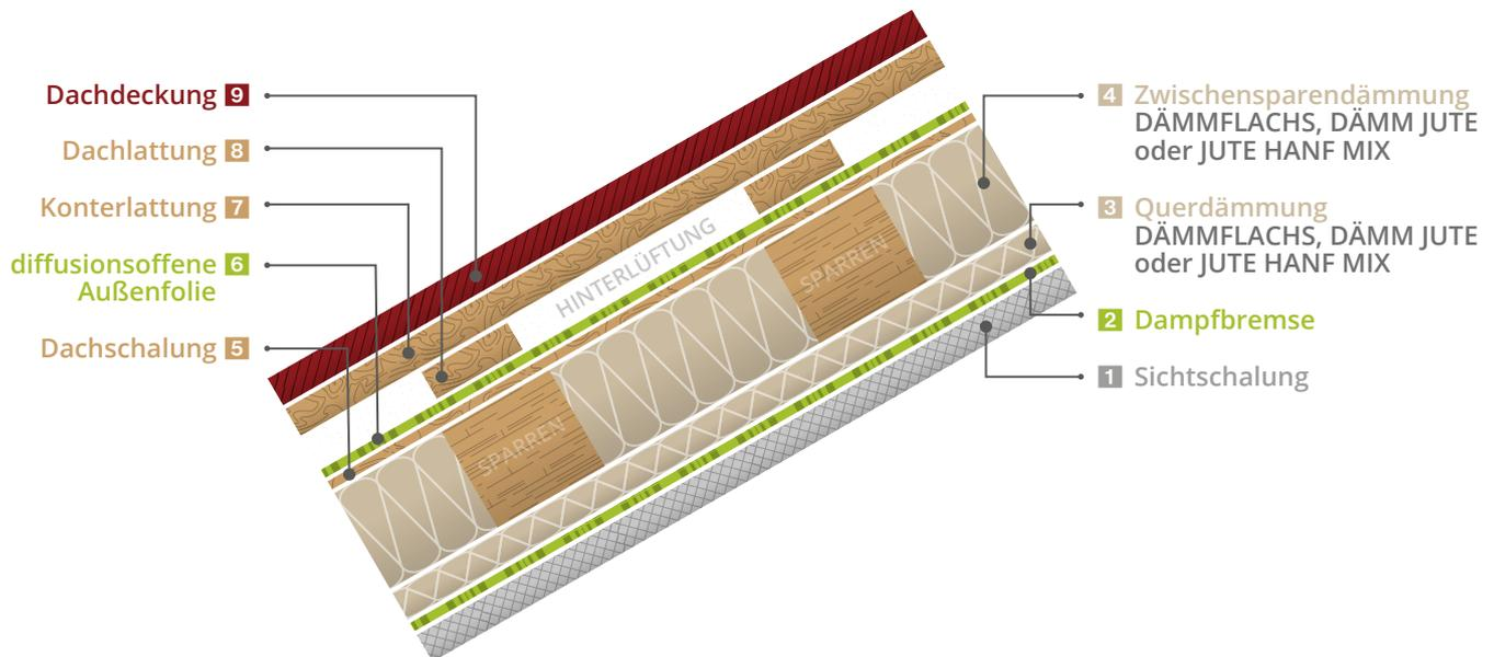
Die **3 Querdämmung** trägt wesentlich zur Verbesserung der Dämmwirkung bei. Denn die Hitze überträgt sich von oben über die Dachschalung und Sparren nach innen zur Sichtschalung. Durch die Querisolierung wird der Sparren entkoppelt und der Hitzeschutz maximiert.
